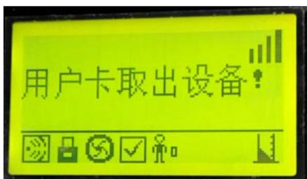
用户用完水再次刷卡，此时终端设备中用户数据重新写回卡内，显示“用户卡取出设备”，水泵关闭，可允许其他用户卡操作取水。
