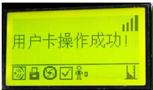
针对一机多卡终端，用户刷卡取水操作，显示“用户卡操作成功”水泵正常开启可以取水。
